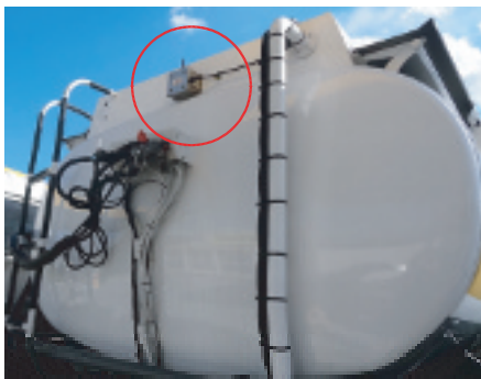
写真5 移動タンク貯蔵所に設置された無線ユニット
