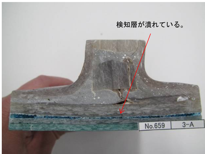
写真3.6.3 検知層の潰れ状況 (KHK659 3-A)
