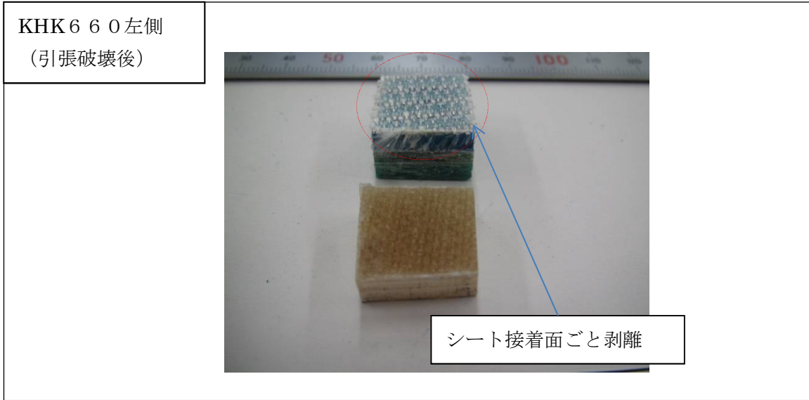
図3.7.16 引張破壊後試料 (KHK660左側) 状況
