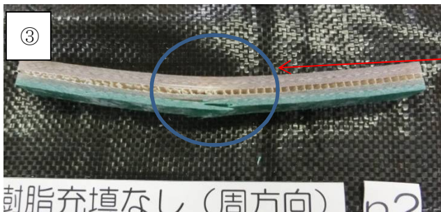
図 16 周方向試験片結果 (n 2)
