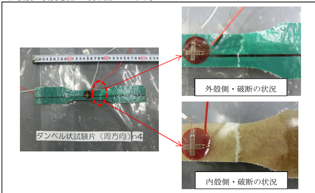
図 18 試験後の状況（ダンベル状試験片・周方向・n4）
