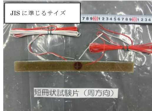
写真8 試験片形状の検討用試験片 (短冊状・周方向)
