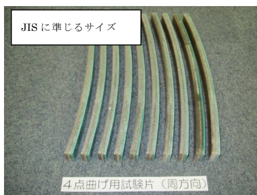
写真5 試験方法の検討用試験片 (4点曲げ用・周方向)
