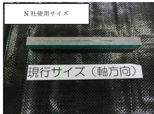
写真10 試験片寸法の検討用試験片 (現行サイズ・軸方向)
