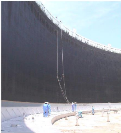
図4 側板内面からの連続板厚測定例（浮き屋根式タンク）
