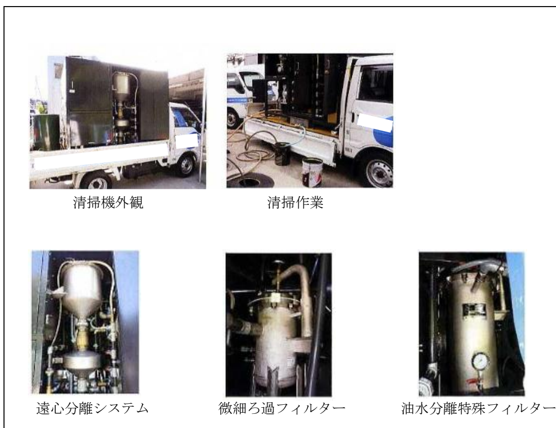
写真 4.2.4 白濁混合した含有水分を除去可能な清掃機
