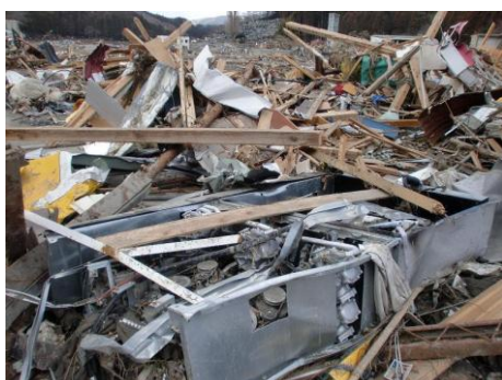
写真 2.2.8 流された固定給油設備 (日本ガソリン計量機工業会提供写真)
