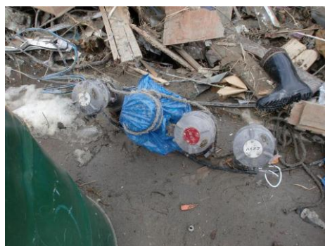
写真 2.2.16 蓋の外れた注入口 (日本ガソリン計量機工業会提供写真)
