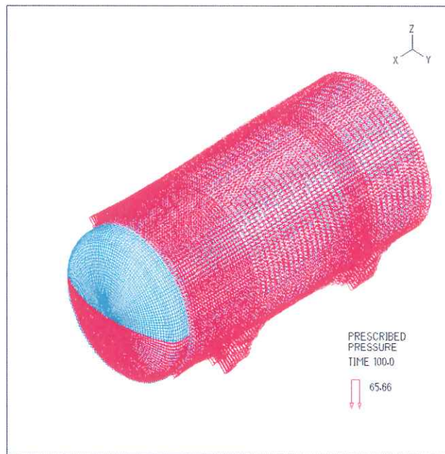
図 2-7 鋼製タンク圧力荷重
