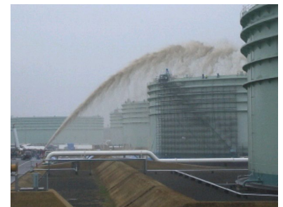
写真 5 大容量泡放射試験の状況
