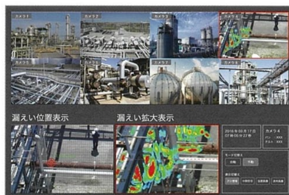
図1 ガス広域監視システム概要 (コニカミノルタ株式会社ガス広域監視システムパンフレットより)
