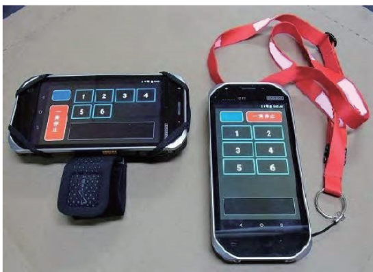
図4※ 落下防止対策(1) (左：腕バンド、右：首掛けストラップ)
