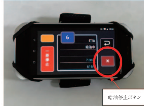
図3* 可搬式の制御機器(給油中)
