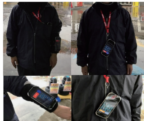
図5※ 落下防止対策(2) (左：腕バンド、右：首掛けストラップ)
