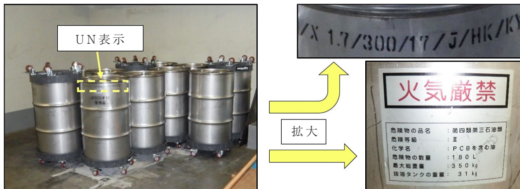
写真5 PCB運搬容器
