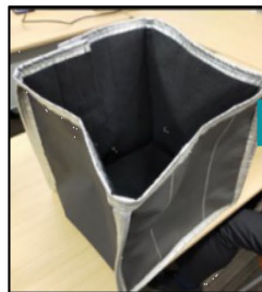
図4-6 耐火性を有する布で換気口を覆うイメージ
