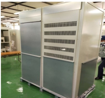
図4-5 換気口に鋼板を貼り付け一時貯蔵
