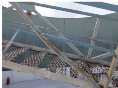
ローリングラダートラスアングル変形/擦り跡 ラダーの上にアトモス弁の破片残存
