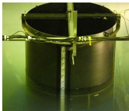
図9 対策工法1 浸水実験
