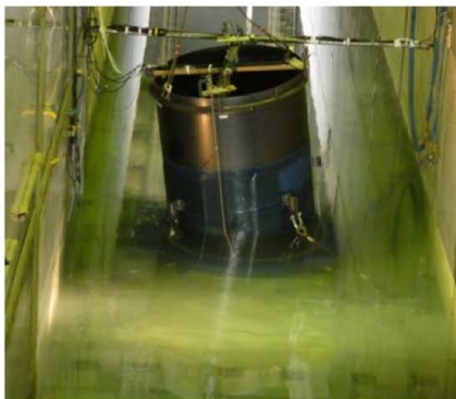
図8 無対策タンク 浸水実験
