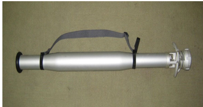
写真5 従来の泡ノズルの外観（例）
