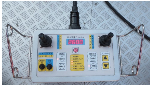
写真3 有線リモコン型のコントローラーの外観（例）
