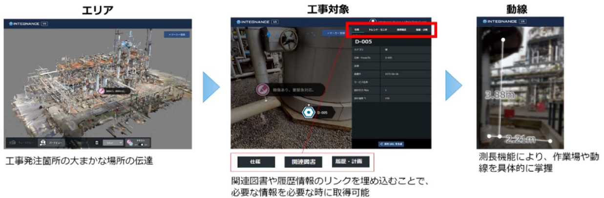
第4図 VRを活用した協力会社との工事前打合せの流れ
