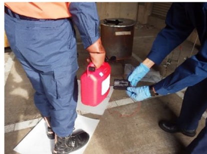
揺動後の運搬容器の表面電位計測状況
