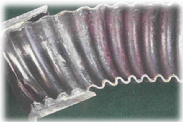
取り外した可とう管継手
