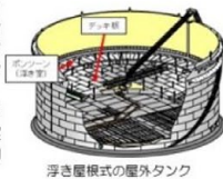
浮き屋根式の屋外タンク
