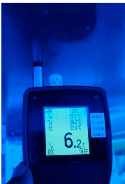
図.11 施工環境の確認
