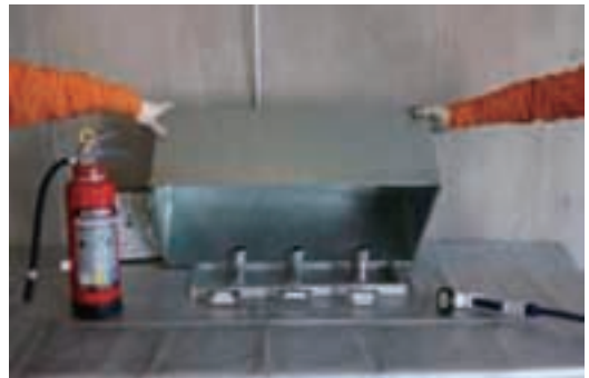
写真9 不燃性の箱による窒息消火
