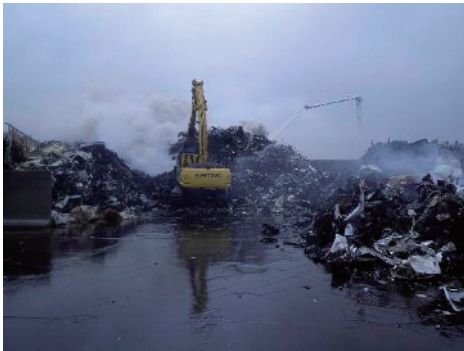
写真2 重機を用いた消火作業
