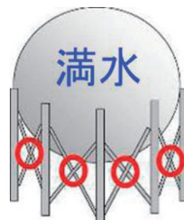
図-1 地震で球形タンクの柱が折れる
