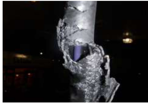
写真1 ノズルNo.5とNo.6を収容するデリベリユニットと損傷した給油ホース 写真2 ノズルNo.5の給油ホース損傷部分
