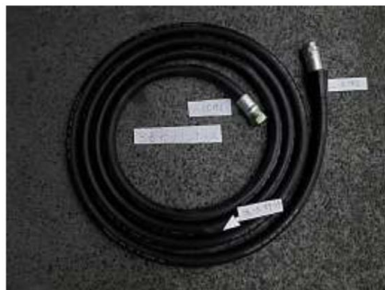
写真6 取り外したノズルNo.3の 給油ホース
