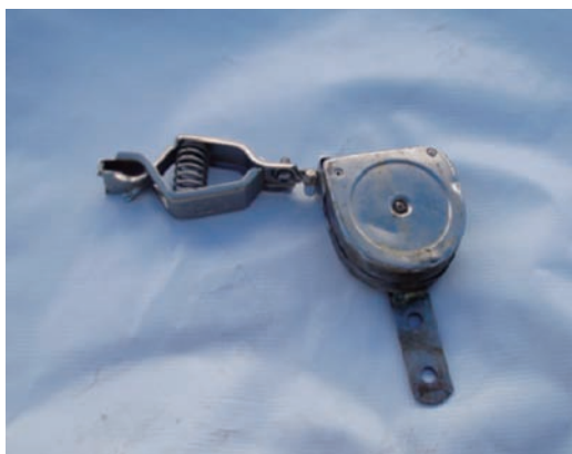
写真1 タイプA：自動巻き取り式（リール式）アース線
