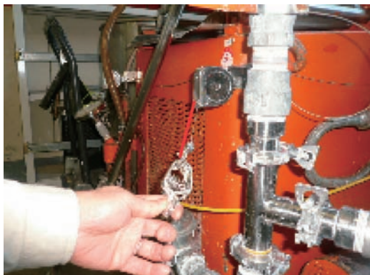
写真2 タイプA：自動巻取り式アース線の使用状況
