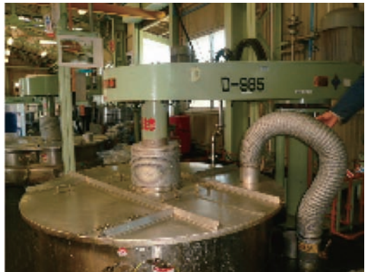
写真9 タンクのカバー（シャフトと接触する可能性のある部分は純アルミ使用） 蛇腹状カバーによるシャフト部の密閉化、およびタンクからの排気ダクト
