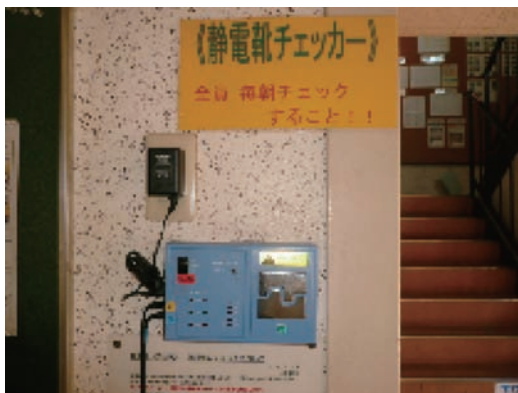
写真8 チェッカーによる作業員の導通チェック（毎朝、全員）
